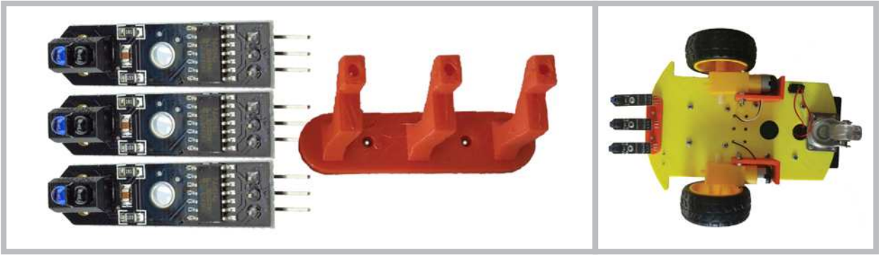
a. Çizgi izleme sensörleri ve montaj aparatı
