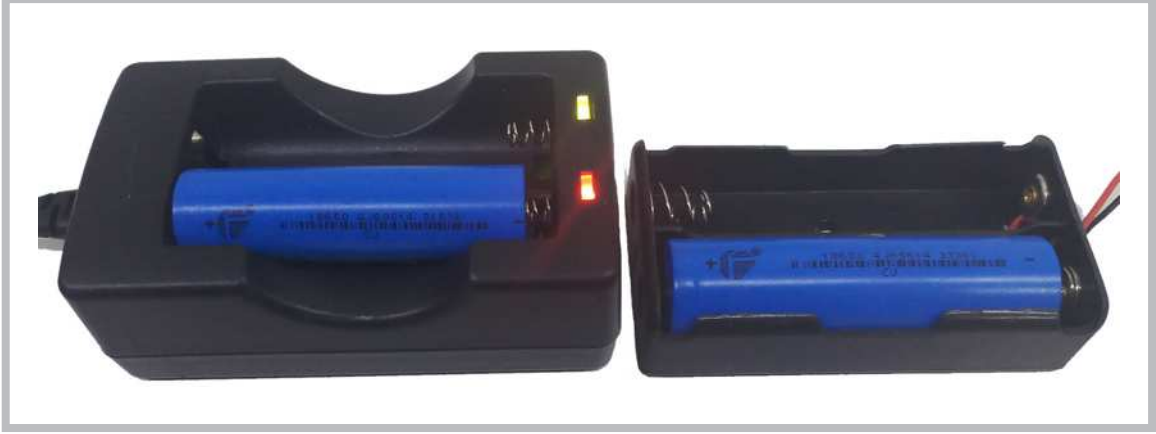
Görsel 3.11: Lion 18650 piller, şarj cihazı ve pil yatağı
